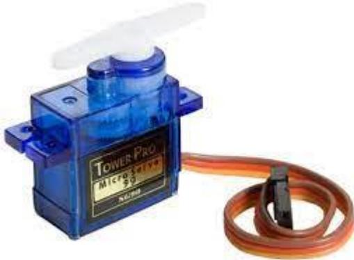
Tienen un propósito diferente al de aquellos que son capaces de permanecer girando por tiempo indefinido. La diferencia con otros tipos de motores es que los servomotores no ofrecen un giro continuo, en un servo indicamos el ángulo de giro deseado del eje del motor y el servo se encarga de posicionarse en este ángulo. Tienen internamente unos topes y su giro está generalmente limitado de 0 a 180° (otros modelos más atípicos pueden realizar giros diferentes tales como los de 360 grados).
