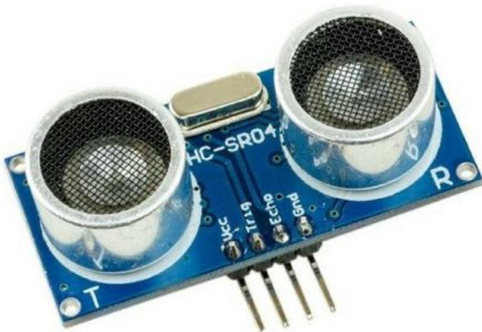
Su funcionalidad en su mayoría se debe a los dos transductores que posee: un emisor y un receptor piezoeléctricos, además de la electrónica necesaria para su operación. El funcionamiento del sensor es el siguiente:
